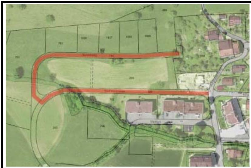
Der Strassenkörper wird mit für Erschliessungsstrassen üblichen Dimensionen ausgebildet. Der Belag wird zweischichtig mit einer Gesamtstärke von 10,5 cm ausgeführt. Aufgrund des wenig tragfähigen Untergrunds wird eine Kofferstärke von insgesamt 50 cm vorgesehen.
